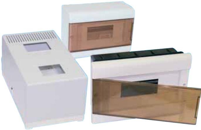
**НАЗНАЧЕНИЕ:** применяются для установки автоматических выключателей, устройств защитного отключения и счетчиков (арт. 68021) в электрических сетях с открытой и скрытой проводкой. Щитки на 6 и более автоматов укомплектованы дин-рейкой и заземляющей шиной. В комплектацию к щитку квартирному (арт. 68021) входят 3 болта с гайками для установки счетчика, а также 4 винта с пластиковыми дюбелями для крепления корпуса щитка к стене.
